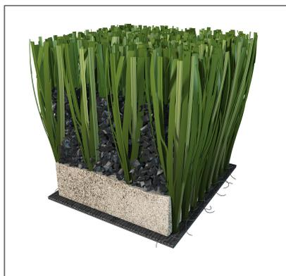
Sistema de césped artificial de última generación, fabricado mediante sistema TUFTING de una medida de galga 5/8" con 12 punt/dm, resultando 7.500 punt/m<sup>2</sup> con filamentos del césped en verde bicolor de 45 mm de altura y 19.000 Dtex.
